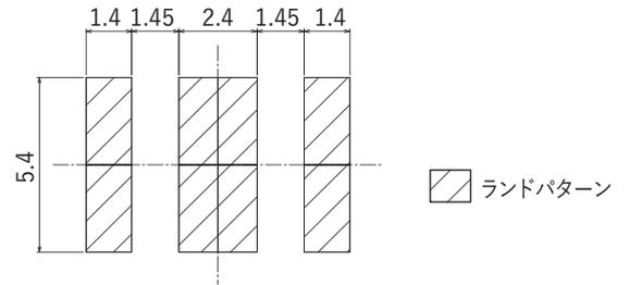
サージ電流耐性向上の為、銅箔厚みは70 $\mu$ mを推奨します。
