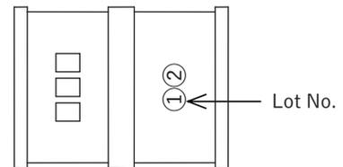
□□□……………直流放電開始電圧 例)R5K3-231P65U→231
