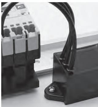
本製品をF-QuiQシリーズにご使用の際は、ビニールコードにフェルール端子を接続してください。適合可能なフェルール端子は別途お問い合わせください。特に開閉頻度の高い、振動が大きい場合は脱落防止の為、ネジ止めでの固定を推奨いたします。なお、板ばねで取り付けの場合はネジ止めとの併用はできません。
