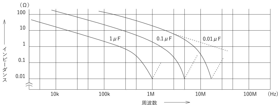
この特性はノイズサプレッションキャパシタの一般傾向を示します。個々の製品の静電容量のバラツキによって共振点が変動する他、測定方法(特にリード線の長さ)によって大きく変動しますのでご注意ください。
