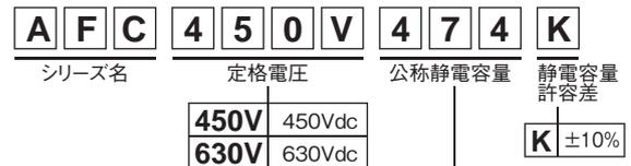
容量 (pF) を最初の2桁で表し、第3数字は続く0の数を表します。
